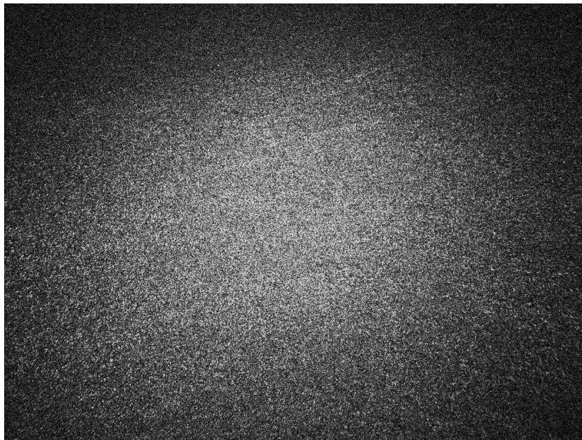
Figura 2.13: Exemplo de um padrão de speckle.
