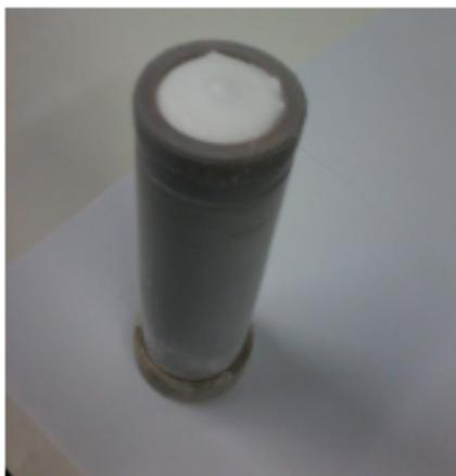
Figura 4.9: Recipiente usado no congelamento da amostra líquida. O recipiente possui dois compartimentos: um menor, onde se introduz 20 ml da amostra a ser congelar, e outro maior que é preenchido com água e serve como dedo frio, mantendo a amostra congelada por mais tempo.
