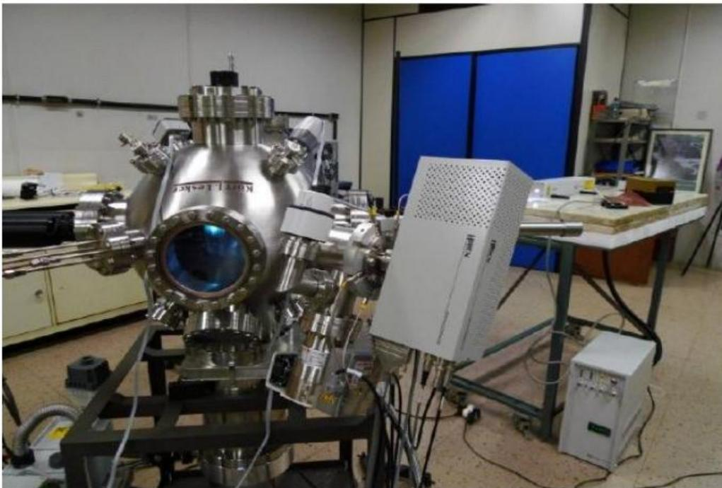
Figura 3.2: Sistema para deposição por ablação por laser do IF-UFF.
