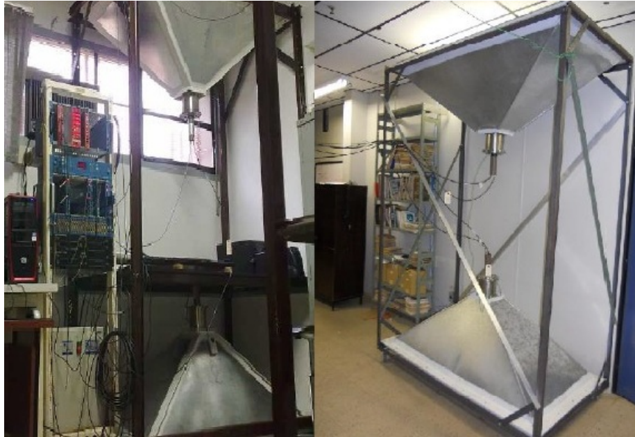
Figura 2.5: Fotografia dos telescópios de múons: à esquerda podemos ver um dos dois telescópios Muonca (Campinas-SP), à direita vemos um dos dois telescópios New Tupi (Niterói-RJ).
