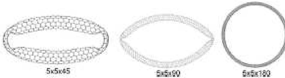
Figura 1.17: Configurações estáveis de CNs deformados adiabaticamente para gerar um torus. Um deles levou a formação de um torus perfeito[47].
