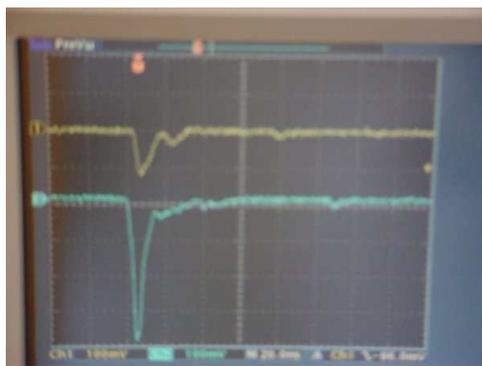
Figura 2.6: Sinais analógicos (detectores A e B) em coincidência observados na tela de um osciloscópio.
