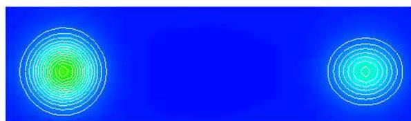
Figura 5.14: Densidade eletrônica dos íons Fe4 (pico esquerdo) e Fe2 projetada no plano (010) (plano  $ac$ ). A projeção foi feita de  $z = 0.00$  a  $z = 0.20$ ,  $\rho_{\text{mín.}} = 101.5 \text{ el./\AA}^3$ ,  $\rho_{\text{máx.}} = 1000 \text{ el./\AA}^3$  e o intervalo é de  $35.00 \text{ el./\AA}^3$ .
