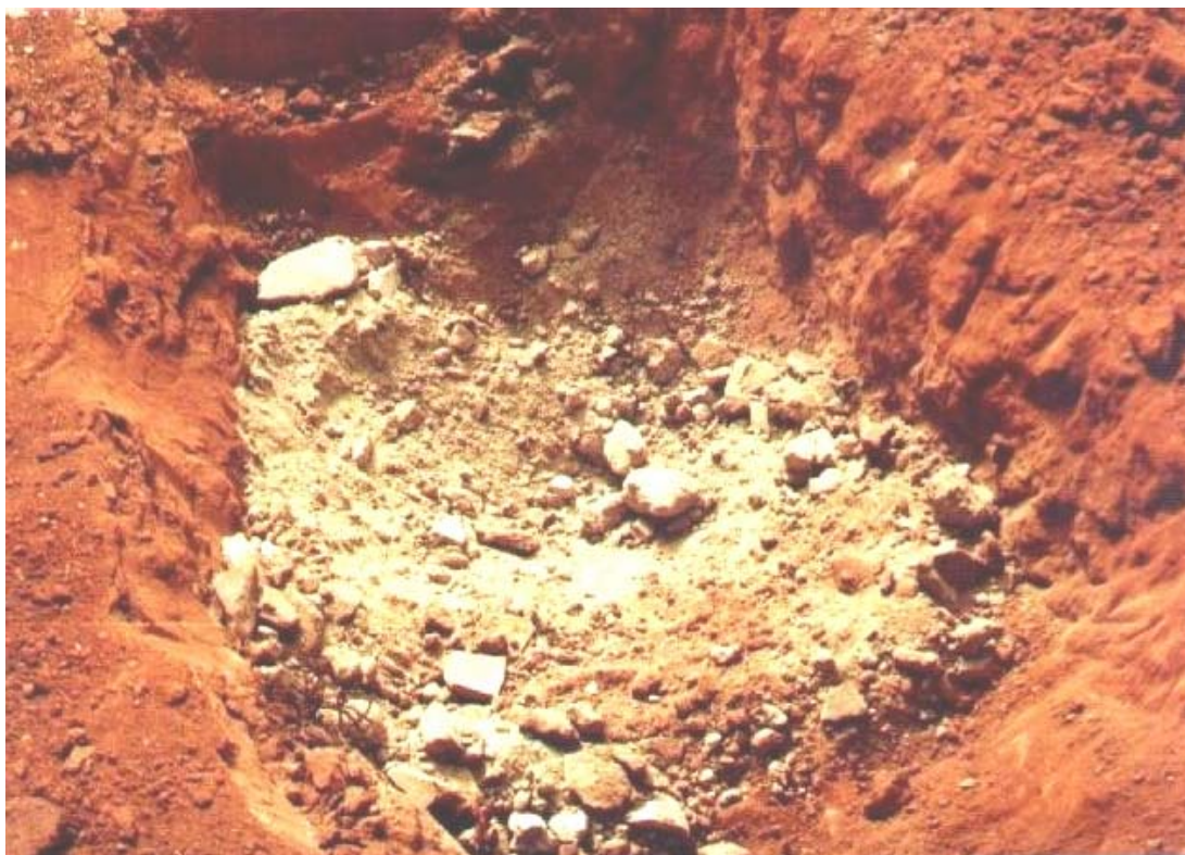
Figura 4.2: Foto da camada de entulho contaminado por ^{137}\text{Cs} a poucos centímetros da superfície do terreno estudado [Facure, 2001c].
