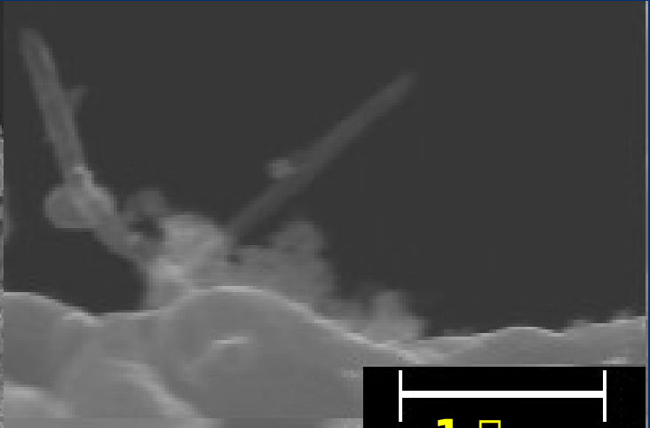
MEV dos pellets de Ni + CNT
