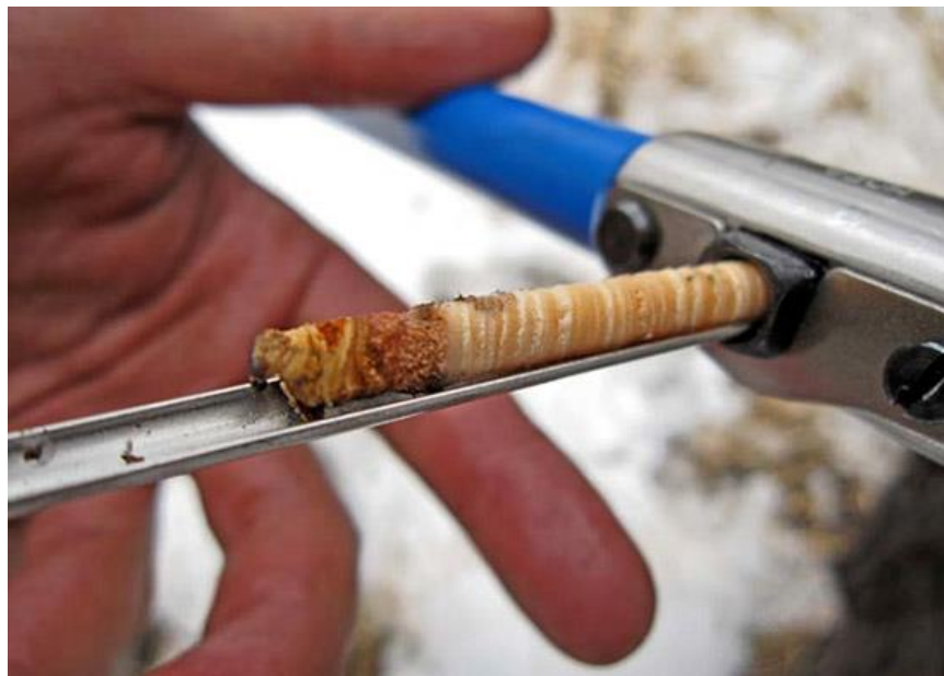
Figura 3.7 Trado, utilizado para retirar o incremento radial da árvore. Fonte: http://ringwidth.com/gallery/tree-ring-sampling.html
