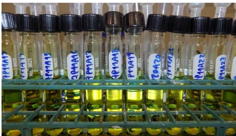
Figura 4.7 Processo de bleaching para extração da celulose
