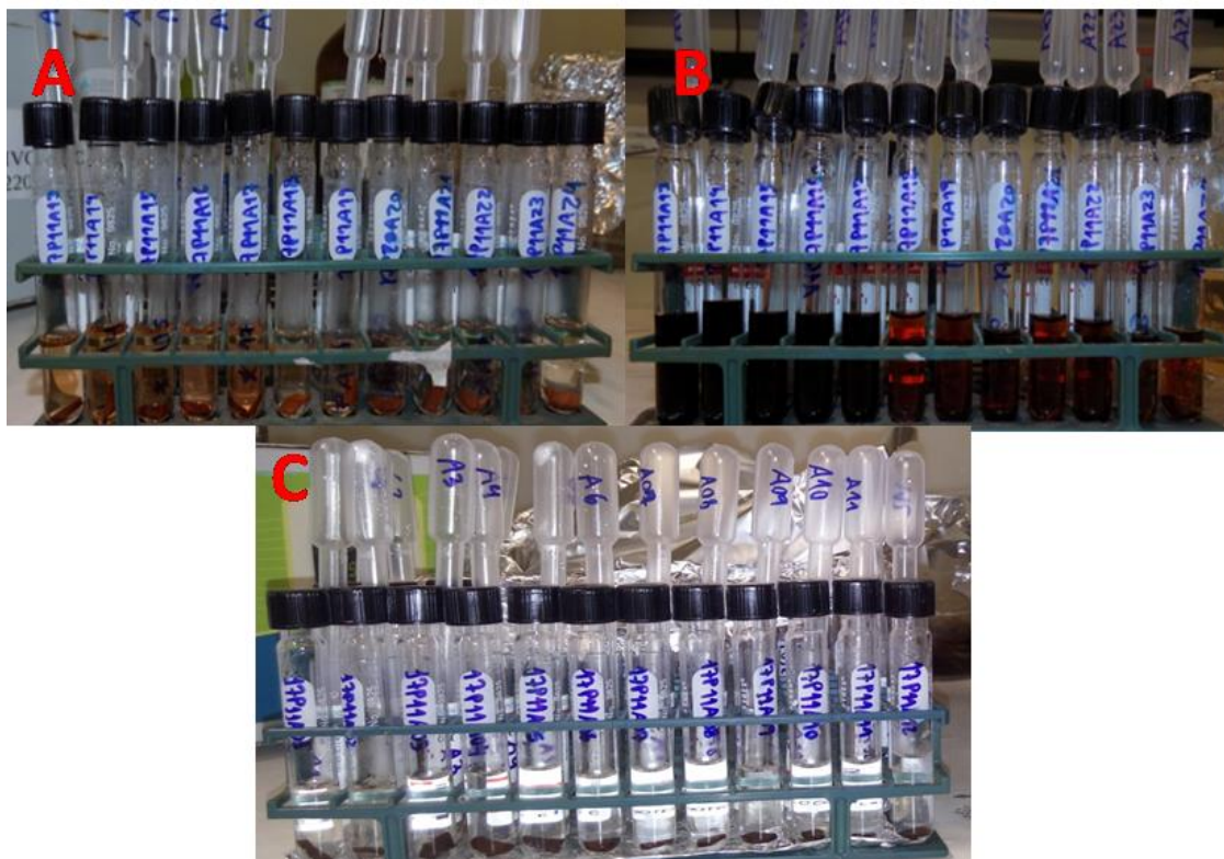
Figura 4.6 Tratamentos ácido (A) e básico (B) e amostras lavadas em H 2 O UP (C).
