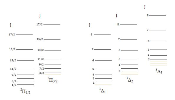
Figura 2-11: Níveis rotacionais de um estado  $^2\Pi$  e um  $^3\Delta$  no caso (a) de Hund. (Figura adaptada de (Herzberg, 1971))
