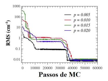
Figura 5-7: Evolução do valor de RMS ao longo do processo de Annealing, em função do valor de p e da quantidade de passos de Monte Carlo. (Figura de autoria própria)
