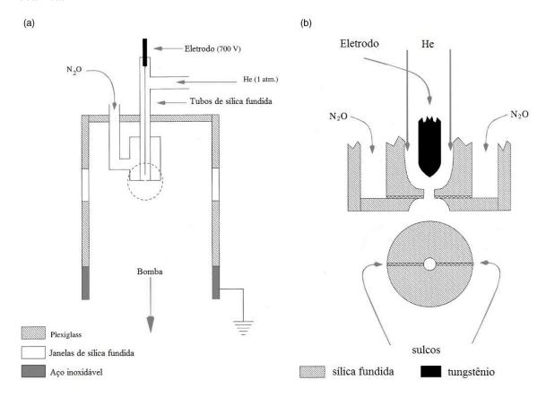
Figura 4-2: (a): Diagrama esquemático do aparato utilizado para realizar a ionização Penning de espectro frio no segundo experimento. (b): Detalhe mostrando como o gás  $N_2O$  chega à região de expansão através das duas ranhuras feitas no tubo de quartzo. (Figura adaptada de (Fellows & Vervloet, 2001))
