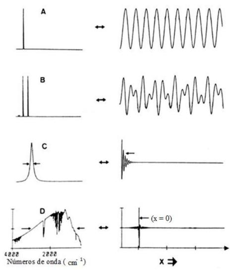
Figura 4-6: Exemplos de espectros (à esquerda) e seus respectivos interferogramas (à direita). (a) - Uma linha monocromática. (b) - Duas linhas monocromáticas. (c) - Linha de Lorentz. (d) - Espectro de banda larga de fonte policromática. (Figura adaptada de (Herres & Gronholz, 1984))
