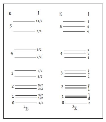
Figura 2-13: Níveis rotacionais de um estado  $^2\Sigma$  e um  $^3\Sigma$  no caso (b) de Hund. (Figura adaptada de (Herzberg, 1971))
