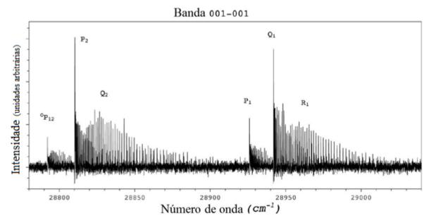
Figura 5-3: Banda 001-001 da transição eletrônica  $A^2\Sigma^+ - X^2\Pi$ . O subíndice "1" se refere à componente com  $\Omega = 1/2$  e o subíndice "2" se refere à componente com  $\Omega = 3/2$ . (Figura de autoria própria)
