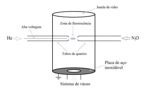
Figura 4-1: Diagrama esquemático do aparato utilizado para realizar a ionização Penning de *espectro quente* do primeiro experimento. (Figura adaptada de (Fellows & Vervloet, 2001))
