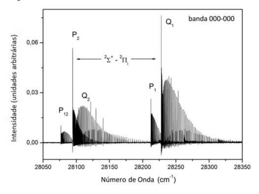
Figura 3-2: Banda vibracional 000-000 da transição eletrônica  $A^2\Sigma^+ - X^2\Pi$  do  $N_2O^+$ .  $P_{12}, P_2$  e  $Q_2$  pertencem à componente  ${}^2\Pi_{\frac{1}{2}}$  e  $P_1$  e  $Q_1$  pertencem à componente  ${}^2\Pi_{\frac{3}{2}}$ . (Figura de (Fellows, 2013))
