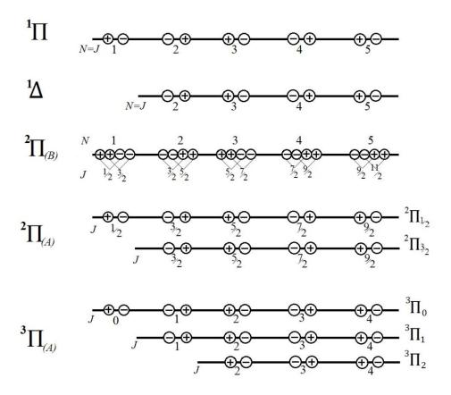
Figura 2-9: Paridade dos níveis rotacionais de estados eletrônicos  $\Pi$  e  $\Delta$ . Os subscritos (A) e (B) denotam o caso de Hund em que se encontra o nível representado. (Figura de autoria própria)
