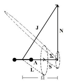
Figura 2-10: Diagrama vetorial para o caso (a) de Hund. (Figura adaptada de (Herzberg, 1971))
