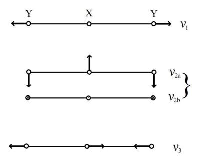
Figura 2-3: Vibrações normais de uma molécula linear  $XY_2$ . (Figura adaptada de (Herzberg, 1971))
