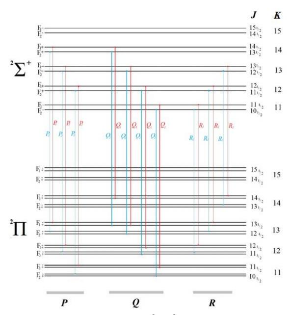
Figura 3-3: Ramas Principais da transição  $A^2\Sigma^+ - X^2\Pi$ . (Figura de autoria própria)
