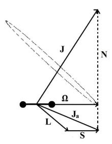
Figura 2-14: Diagrama vetorial para o caso (c) de Hund. (Figura adaptada de (Herzberg, 1939))
