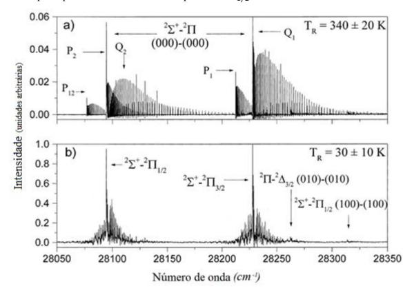
Figura 4-3: Espectros quente (a) e frio (b) da banda 000-000 da transição  $A^2\Sigma^+ - X^2\Pi$  da molécula  $N_2O^+$ , produzidos respectivamente pelo primeiro (Figura 4-1) e pelo segundo (Figura 4-2) aparatos. (Figura de (Fellows & Vervloet, 2001))
