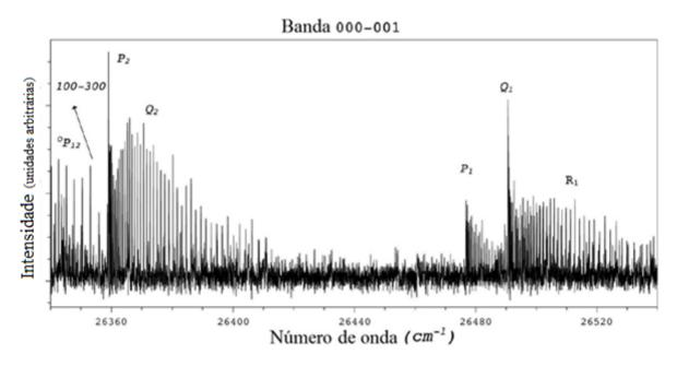
Figura 5-2: Banda 000-001 da transição eletrônica  $A^2\Sigma^+ - X^2\Pi$ . As linhas da rama  $R_1$  da banda 100-300 também podem ser observadas. O subíndice "1" se refere à componente com  $\Omega=1/2$  e o subíndice "2" se refere à componente com  $\Omega=3/2$ . (Figura de autoria própria)
