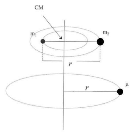
Figura 2-2: Representação da molécula diatômica com um núcleo com massa  $m_1$  e outro com massa  $m_2$  e de sua aproximação como uma molécula monoatômica cuja massa nuclear é  $\mu$ . (Figura adaptada pela autora)
