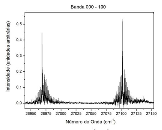
Figura 5-4: Banda 000 - 100 da transição eletrônica  $A^2\Sigma^+ - X^2\Pi$ . (Figura de autoria própria)
