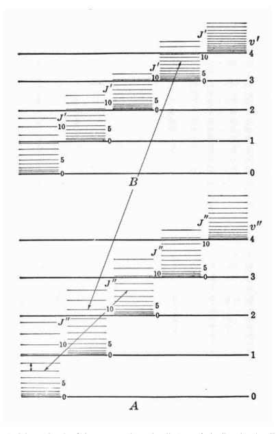
Figura 2-1: A e B são dois estados eletrônicos consecutivos, v' e v'' são os níveis vibracionais e J' e J'' são os níveis rotacionais de uma molécula. Figura do livro (Herzberg, 1971)
