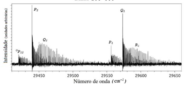
Figura 5-1: Espectro da transição eletrônica  $A^2\Sigma^+ - X^2\Pi$ , banda 100-000. O subíndice "1" se refere à componente com  $\Omega = 3/2$ , enquanto o subíndice "2" e a transição secundária  $^0P_{12}$  se referem à componente com  $\Omega = 1/2$ . (Figura de autoria própria)
