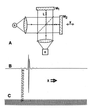
Figura 4-5: (a) - Esquema de um Interferômetro de Michelson. (b) - Interferograma obtido através do detector. (c) - Padrão de interferência da fonte laser. (Figura de (Herres & Gronholz, 1984))
