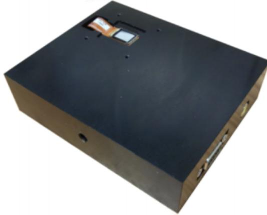
Figura 22: SLM de baixo custo da *Cambridge Correlator*, utilizado na parte experimental desse trabalho. Ele opera com comprimentos de onda de 430nm até 650nm, e possui uma área útil de 4.3-7mm [19].
