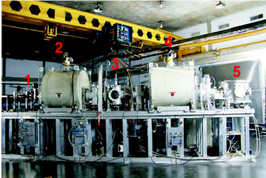
Figura 3.6: Foto do sistema de duplo solenóides no RIBRAS.
