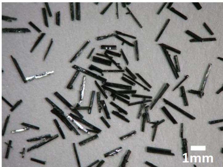
Figura 3.1: Micrografia dos cristais de  $\text{Co}_5\text{Sn}(\text{O}_2\text{BO}_3)_2$ .
