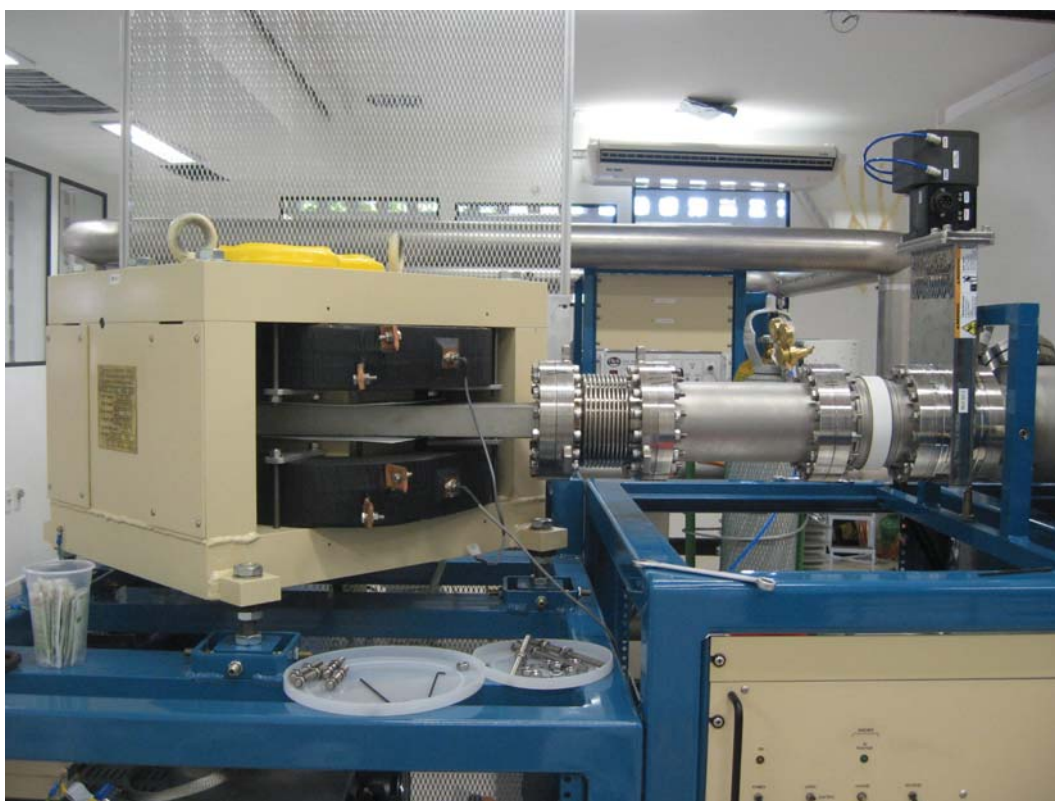
Figura 3.6: Injetor magnético que separa a massa. Íons moleculares ainda estão presentes nesse estágio.
