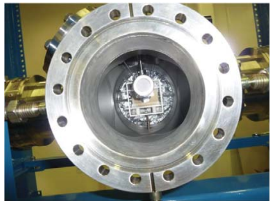
Figura A.12: Colocando os copos de Faraday.
