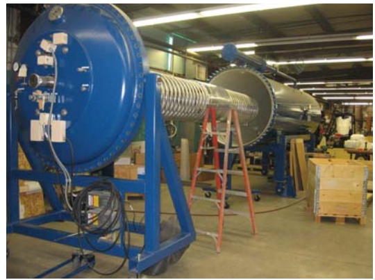
Figura A.2: SSAMS em construção na NEC.
