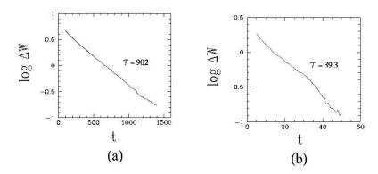
Figura 2.13: Evolução temporal do desvio  $\Delta W(L,t)$  para DB em d=2, para os tamanhos L=512 (a) e L=64 (b). O coeficiente linear da reta de ajuste na região de alta correlação linear é  $1/\tau$ . O valor de  $\tau$  obtido por ajuste linear direto é indicado para cada tamanho.
