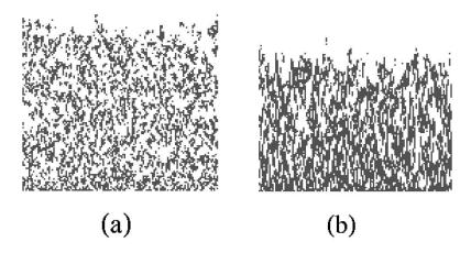
Figura 4.5: Secção reta vertical de depósitos DBB em d=3, para (a) F=1 e (b) F=0.20 em um substrato de volume  $128^2$ . A baixas porosidades, os poros têm uma excentricidade grande na direção vertical, mas a conectividade lateral dos poros é muito mais baixa.
