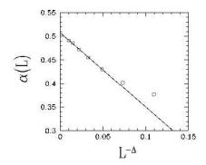
O expoente de rugosidade da deposição balística é consistente com seu valor exato em  $d=2,~\alpha=1/2,$  com correções à escala  $0.6<\Delta<0.8$  [12]. Em d=3,  $\alpha=0.383\pm0.008,$  com correções à escala  $0.3<\Delta<0.8$  [27].
