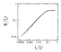
Note que a Eq. 2.7 não determina os expoentes de escala  $\alpha, z$ . Por outro lado, em  $t=t_{\times}$ , devemos ter  $W(t_{\times}) \sim W_{\rm sat}(L)$ , ou, pela Eq. 2.6,  $L^{\beta z} \sim L^{\alpha}$ , donde os expoentes  $\alpha$ ,  $\beta$  e z não podem ser todos independentes, mas atendem à relação de escala
