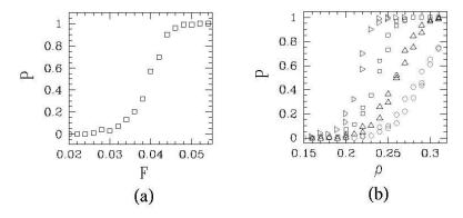
Figura 6.2: Percolação da fase porosa para DBB em d=3. A figura mostra (a) a probabilidade de percolação da fase porosa P versus F, para L=256 fixo, e (b) P versus a porosidade  $\rho$  para depósitos DBB nos tamanho L=256 ( $\triangleright$ ), L=128 ( $\square$ ), L=64 ( $\triangle$ ) e L=32 ( $\bigcirc$ ). Em (b),é possível ver que  $\rho_c\approx 0.20$  ( $F_c\approx 0.04$ , na Fig. (a)) se L>256. As curvas em (a) e (b) são curvas de recobrimento fixo.
