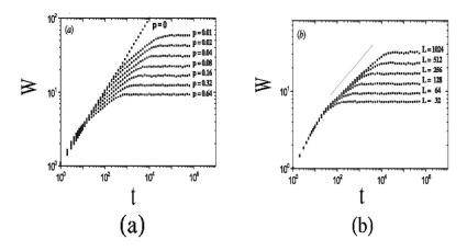
Figura 4.1: Gráficos W versus t para DAR–DA em d=2. Em (a), L=256 é fixado, e p varia como  $p=2^i/100$ , com  $i=0,\cdots,6$ ; em (b), p=0.16 é fixado, e L varia como  $L=2^j$ , com  $j=5,\cdots,10$ . Extraído de [59]. A reta mostrada em (b) tem coeficiente angular  $\beta=1/4$ .
