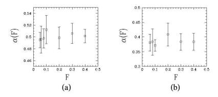
Figura 5.4: Expoentes de rugosidade DBB em (a) d=2 e (b) d=3. Os  $\alpha(F)$  não diferem mais que as barras de erro dos valores KPZ em d=2 ( $\alpha=1/2$ , exato) e d=3 ( $\alpha\approx0.38$ ) para nenhum valor da probabilidade F.
