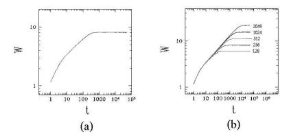
Figura 2.4: A figura (a) mostra a evolução temporal da rugosidade em d=2 para deposição balística em um substrato de tamanho L=256. A figura (b) mostra  $\log W$  versus  $\log t$  para os tamanhos de substrato L=128 a L=2048, também em d=2 dimensões.
