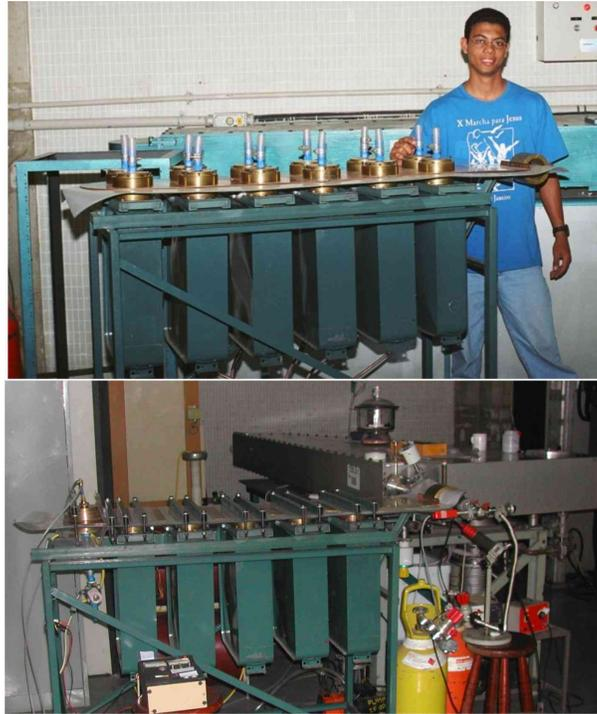
Figura 2.7: Segunda versão da fonte espectral Theta Pinch do IF - UFF
