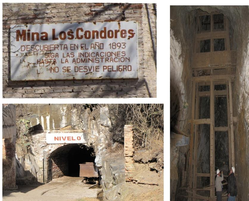
**Figura 3.5:** Fotos ilustrativas da mina Los Cóndores. À direita temos a foto do elevador desativado, que proporciona a saída vertical no fundo do seu túnel principal.
