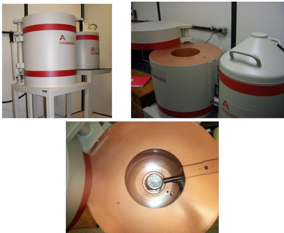
**Figura 3.8:** *Imagens da blindagem de chumbo e do detector de HPGe utilizado no LARA.*
