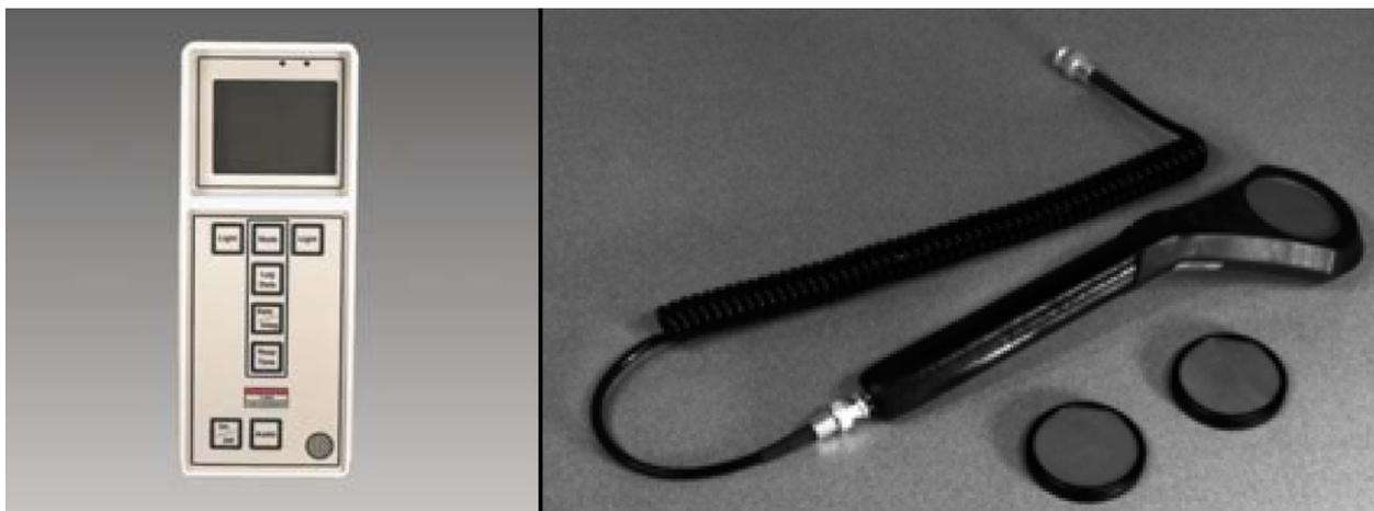
**Figura 3.12:** *Ilustração do dispositivo Geiger-Müller utilizado neste trabalho.*
