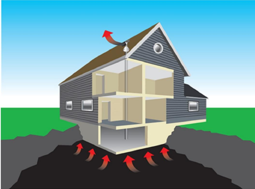
**Figura 2.5:** *Ilustração dos mecanismos utilizado pelo radônio para entrar nas casas a partir do subsolo.*
