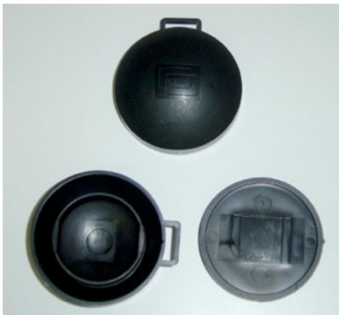
**Figura 3.10:** Monitor NRPB/SSI, câmara de difusão de polipropileno condutor com aproximadamente 5,5 cm de diâmetro e 2,0 cm de altura, onde é introduzida a película de CR-39.
